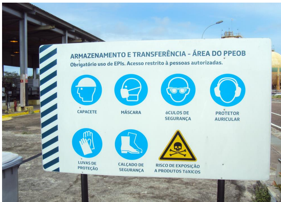
Foto 62: Placa de identificação de área do PPEOB - PROGRAMA DE PREVENÇÃO À EXPOSIÇÃO OCUPACIONAL AO BENZENO (Anexo 13-A, NR-15)
